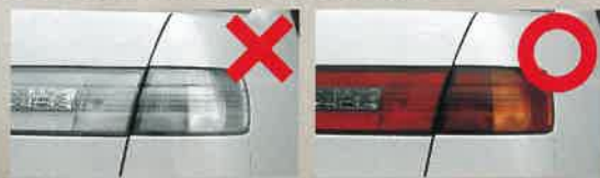
灯火類の色の変更 クリアレンズ等不適切な灯火器及び回転灯等の取り付け
