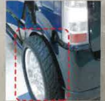
タイヤ及び ホイールの車体 (フェンダー) 外へのはみ出し
